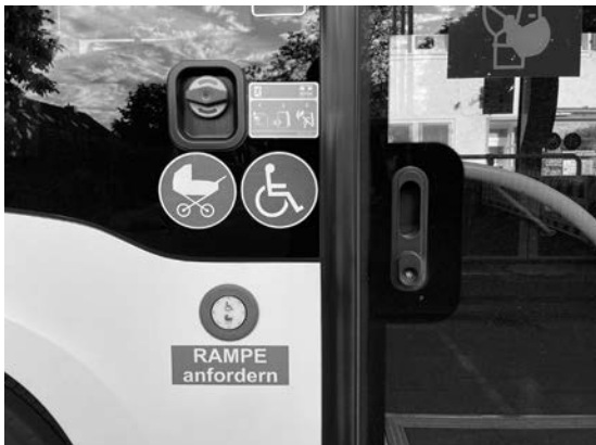
외부에 설치된 비상스위치와 잠금장치
